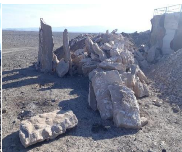
شکل ۹- رسوبات کربناتی خارج شده حاصل از لایروبی چند چاه از قنات قصبه.
