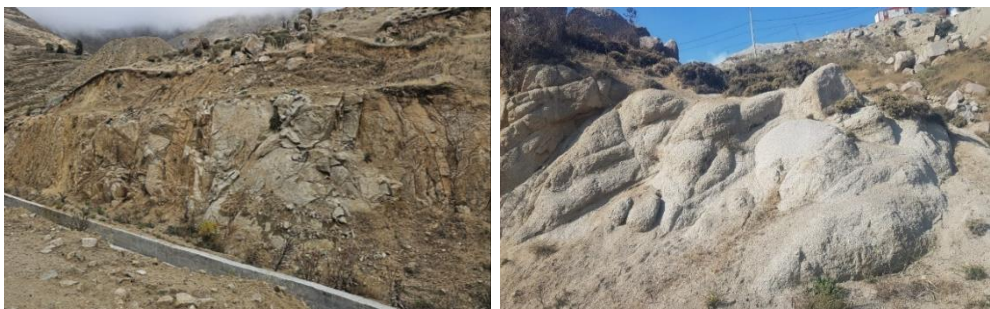
شکل ۴- رخنمون توده سنگ گرانیتی در تکیه گاه چپ (تصویر چپ) با هوازدگی بالا و تکیه گاه راست (تصویر راست) با هوازدگی پایین تا متوسط.
