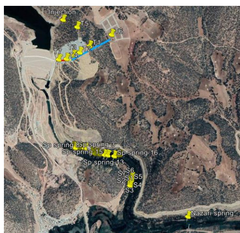
شکل ۶: محل نقطه تزریق ردیاب و نقاط نمونه‌برداری.
