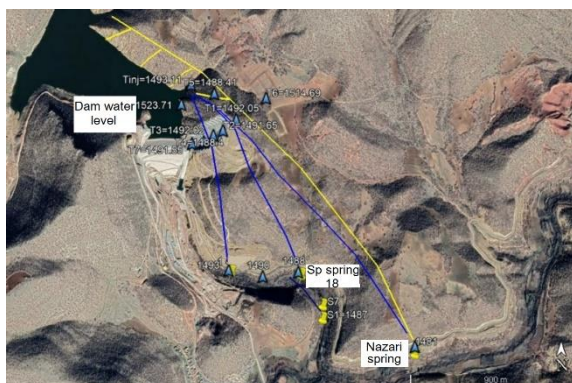
شکل ۱۲: مسیر و محدوده حرکت ماده ردیاب (خطوط آبی) از محل تزریق و خط زرد (مسیرهای احتمالی) به‌طرف پایین دست. Figure 12: Path and extent of tracer movement (blue lines) from injection point and yellow line (probable paths) toward downstream.
