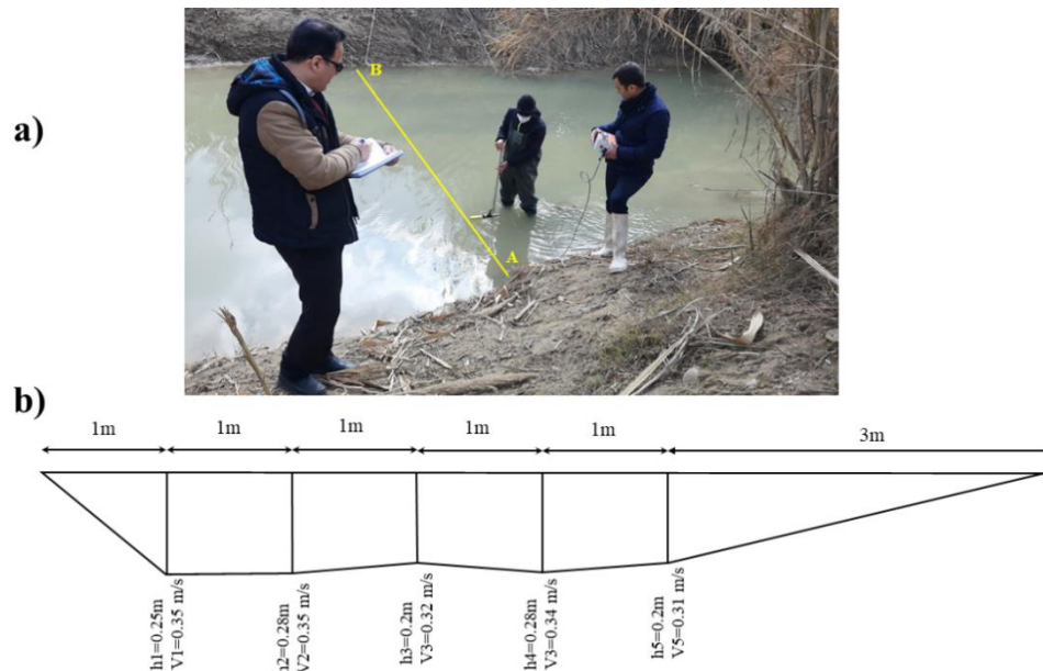
شکل ۵- نمایی از مقطع چهارم اندازه‌گیری سرعت و دبی رودخانه چهل چای در ورودی شهر گنبد.
