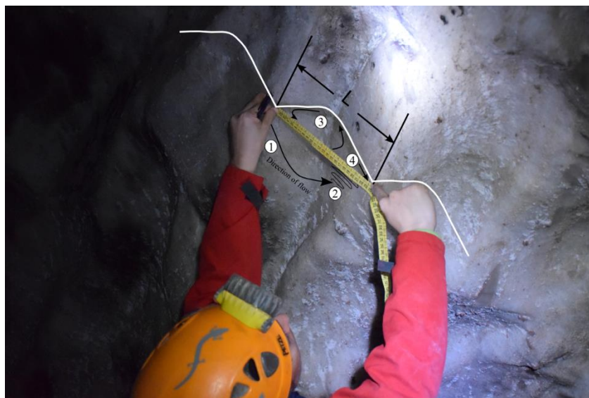
شکل ۴- حرکت سیال در مجاورت اسکالوپ. نقطه ۱. جدایی جریان در تاج. نقطه ۲. گذار جریان برشی لومینار به آشفته. نقطه ۳. چرخش مجدد جریان در ادی نقطه ۴. ناحیه پیوند مجدد جریان جت (Murphy et al., 2017).
