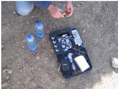
شکل ۳. نمایی از نمونه‌برداری آب توسط نویسنده در محدوده سایت هیپ لیچینگ (سمت راست) و تجهیزات سنجنده همراه جهت اندازه‌گیری برخی پارامترهای فیزیکی آب در محل نمونه‌برداری (سمت چپ)
